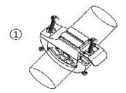
Как показано на рисунке, закрепите кронштейн на руле и вставьте винт в отверстие сверху вниз.
