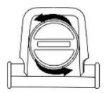
Вставьте монету в прорезь стержня, поверните крышку в направлении стрелки и откройте крышку.
