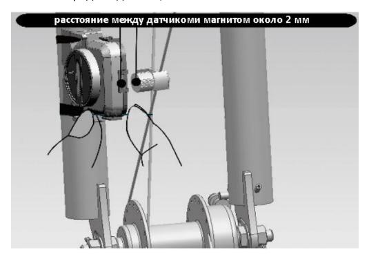
Этот шаг очень важен. После установки датчика и магнита необходимо придвинуть датчик к магниту так, чтобы расстояние между датчиком и магнитом составляло около 2 ММ. Чем меньше расстояние, тем стабильнее передача скорости. Как показано на рисунке выше
